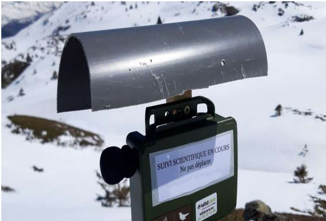
Figure 3: Song-Meter Mini prêt à enregistrer : le microphone, à gauche, est protégé du vent par une bonnette, et le plus gros des précipitations est dévié par une gouttière.
